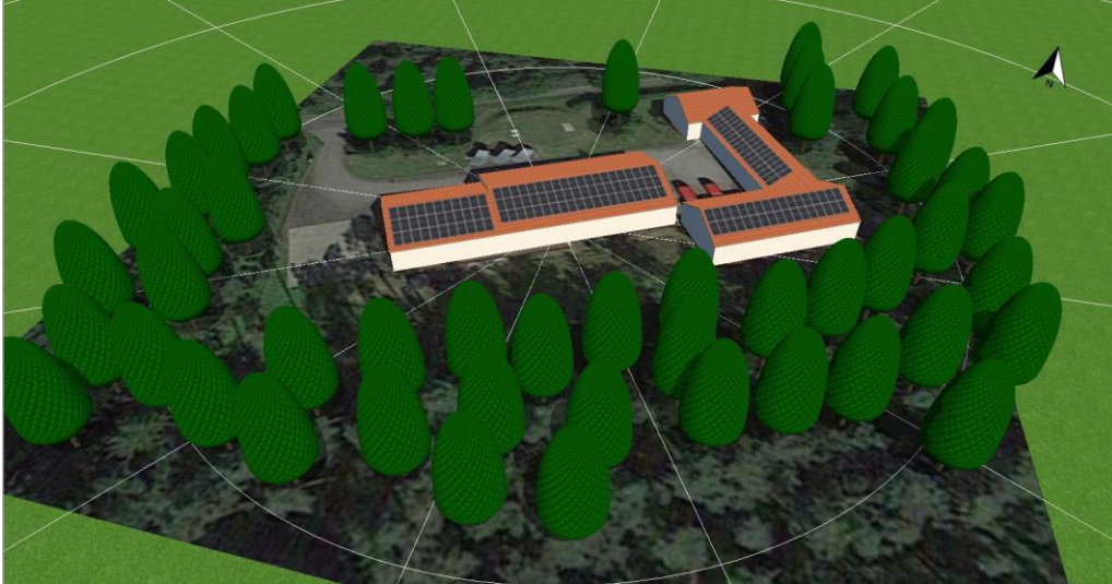
Abbildung 124: Dachbelegung Wasserwerk Variante 1
