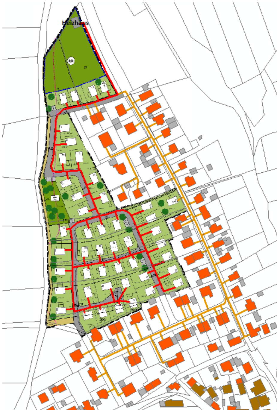
Abbildung 108: Entwurf Wärmenetz Neubaugebiet mit Bestandsgebäuden Oberschöllbach
