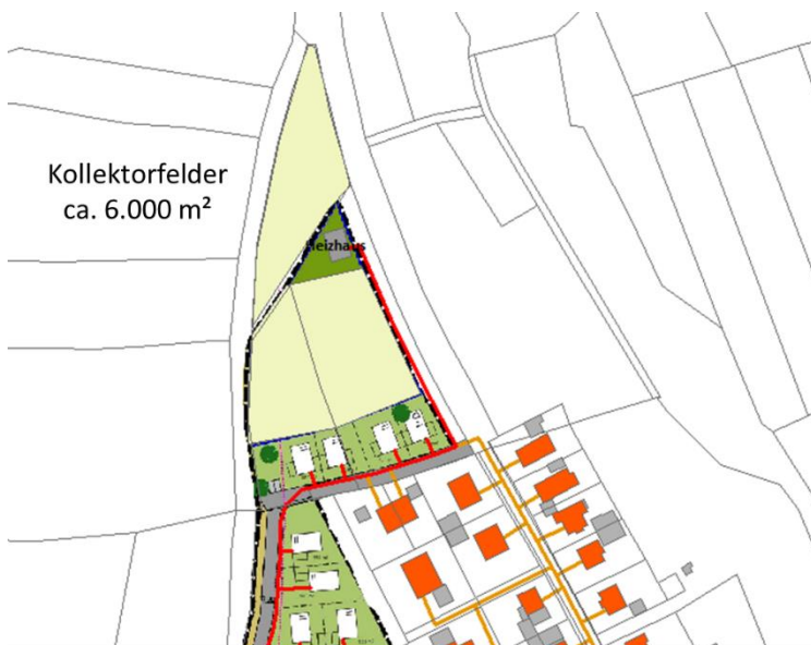
Abbildung 104: Nötiges Kollektorfeld Oberflächennahe Geothermie
